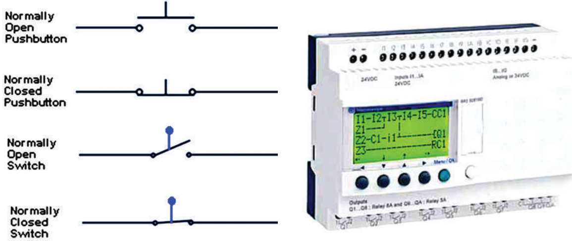
الشكل (6-6): مداخل رقمية لوحدة (PLC).
