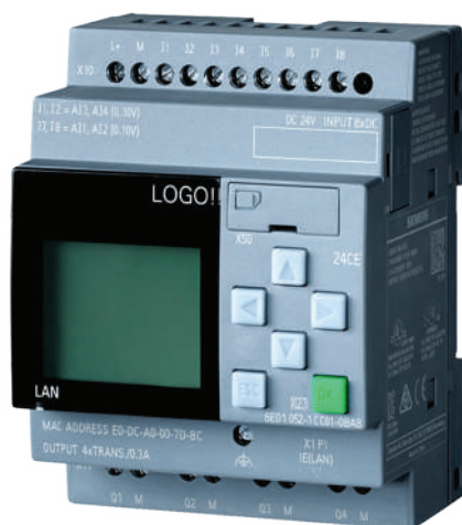
الشكل (12-6): جهاز (PLC) يمكن برمجته يدوياً.
