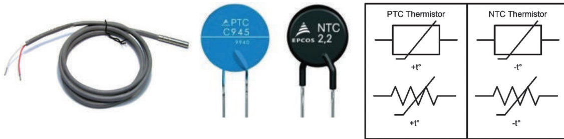
الشكل (37-5): المقاومة ذات المعامل الحراري الموجب والسالب.
