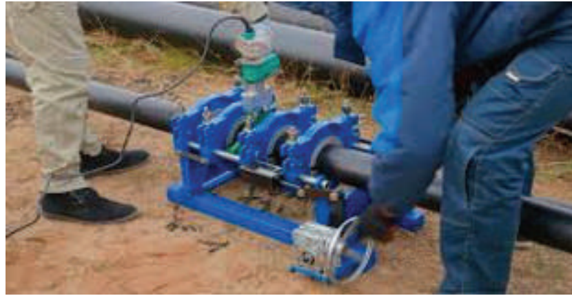
الشكل (4-11): آلة لحام الأنابيب ذات الأقطار الكبيرة.
