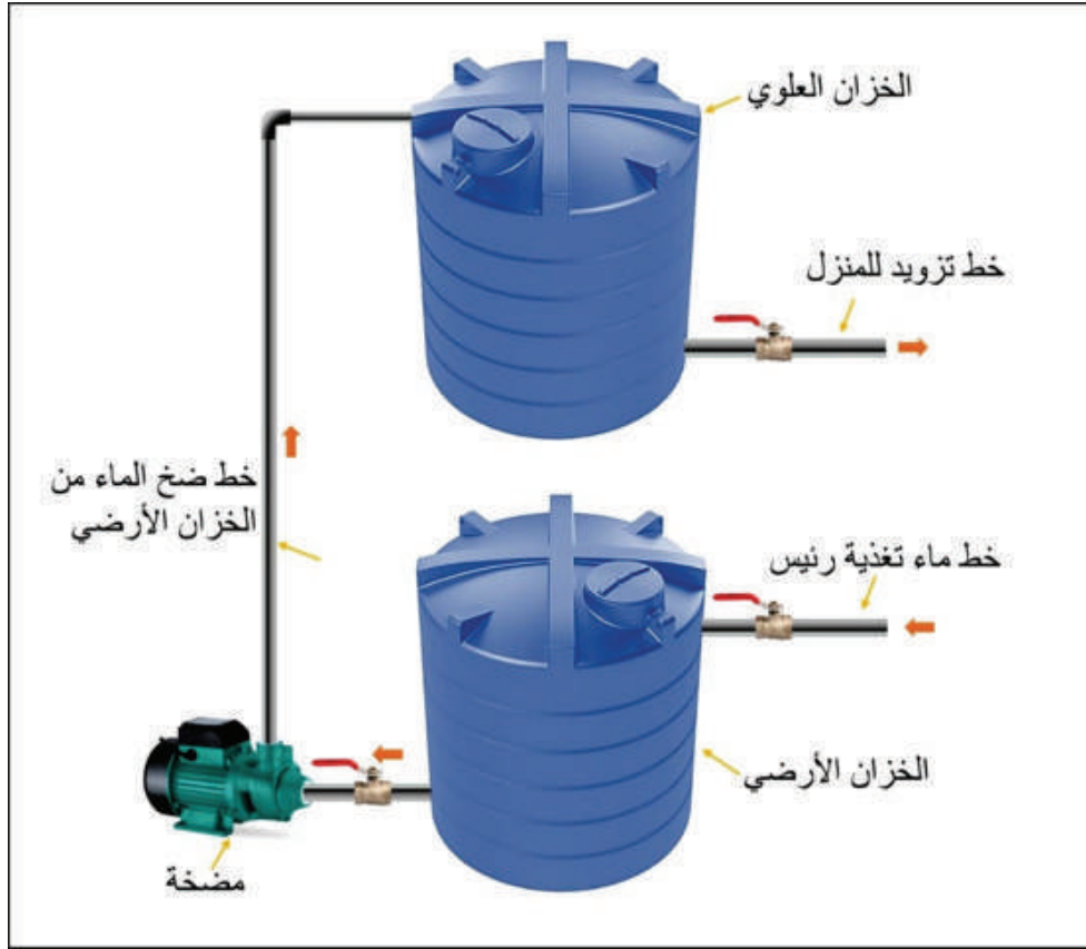
الشكل (3-4): خزانات مياه أرضية وعلوية.
