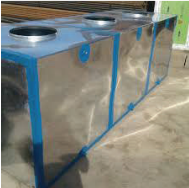
الشكل (3-7): خزان مصنع من الفولاذ المجلفن.
