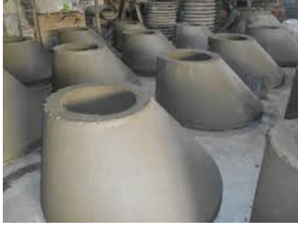
الشكل (3-5) غرفة تفتيش بلاستيكية. الشكل (4-5): حلقة غرفة التفتيش. الشكل (5-5): غرفة التفتيش الأسمنتية.
