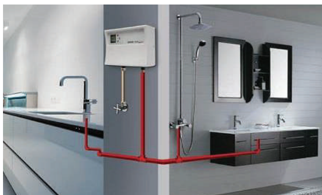
الشكل (11-7): سخان الكهرباء الفوري لمجموعة من القطع الصحية.
