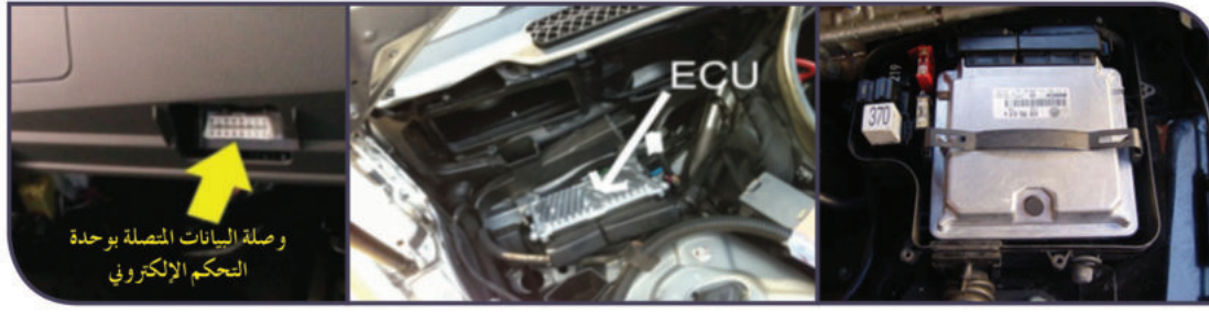
الشكل (1-82): موزع وحدة التحكم الإلكتروني في المركبة.
