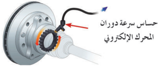
الشكل (3-37): حساس سرعة دوران المحرك الذي يثبت على عمود المرفق في المحرك.
