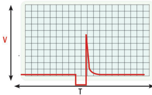
إشارة كهربائية من وحدة التحكم الإلكتروني إلى بخاخ الوقود.
