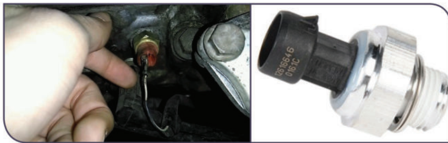
الشكل (1-45): مجس درجة حرارة الزيت في المُحرك.
