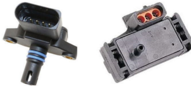
الشكل (1-65): مجس قياس الضغط المطلق داخل مجمع السحب.
