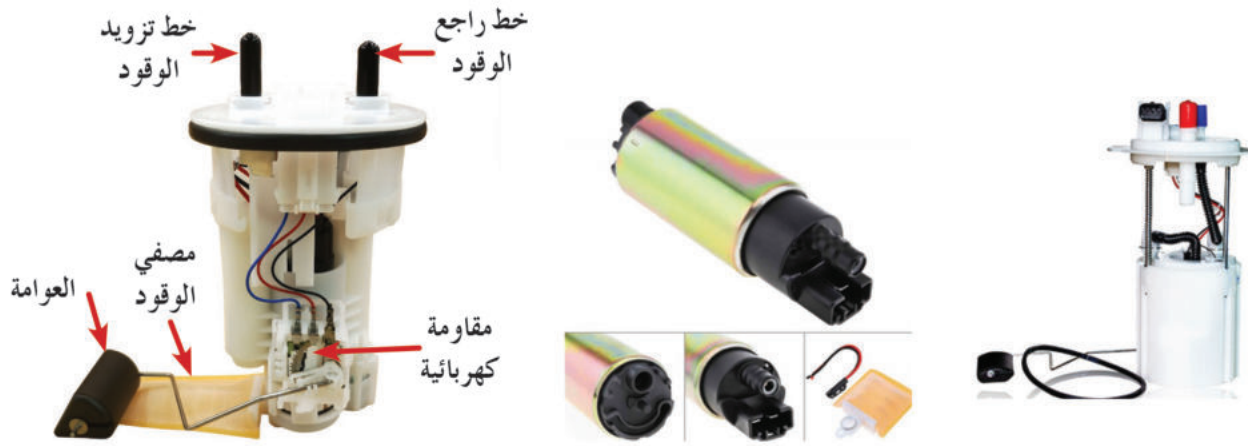
الشكل (1-96): مضخة الوقود الداخلية (الغطاسة).
