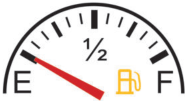
الشكل (3-10): وحدة تدرّيج مُبين سعة الوقود في الخزان.
