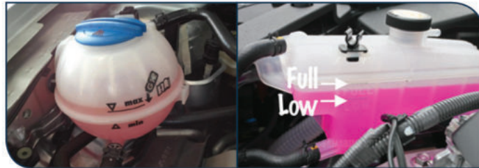
الشكل (1-26): علامات مستوى السائل في خزان التمدد.
