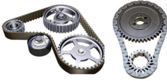
الشكل (14-1): تعشيق مسنني عمود المرفق وعمود الكامات.
