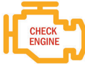
الشكل (1-81): مصباح تحذير وجود عطل في نظام الحقن الإلكتروني.
