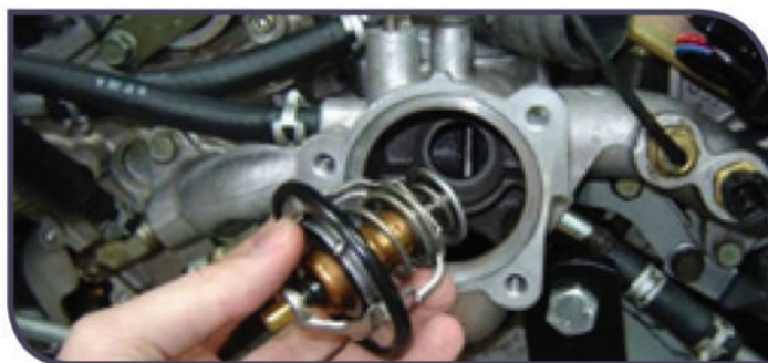
الشكل (1-34): موضع تركيب المنظم الحراري.
