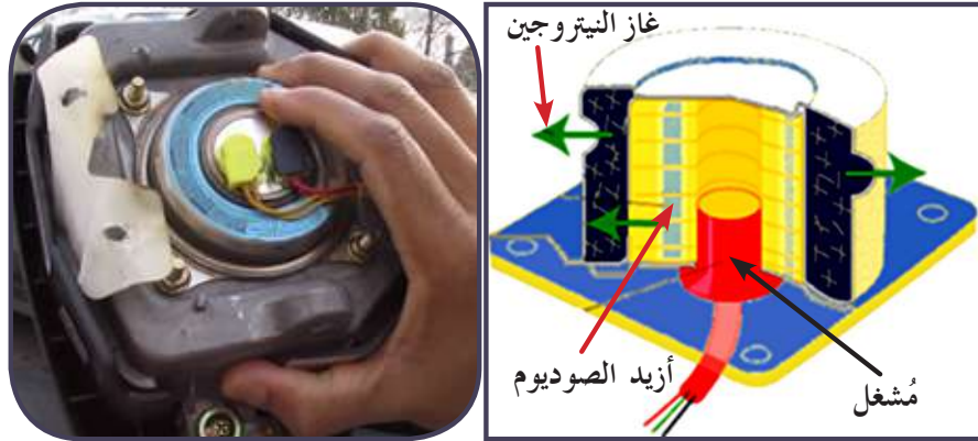
الشكل (5-12): نظام نفخ الوسائد.
