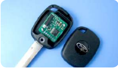
الشكل (5-34): المفتاح الذي يحوي رقاقة إلكترونية.
