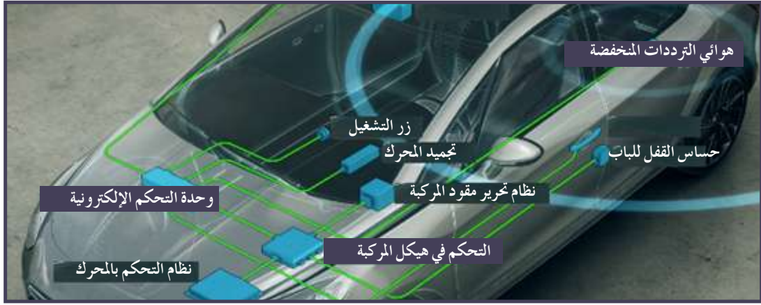
الشكل (5 - 38): الأجزاء المرتبطة في المركبة التي تعمل مع المفتاح الذكي.
