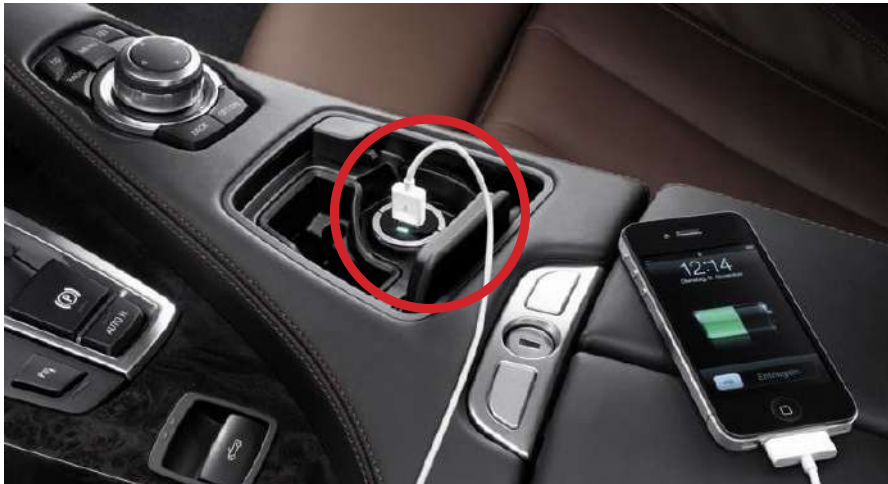
الشكل (4-20): المقبس متعدد الاستعمالات.
