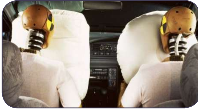
الشكل (5-18): استقرار الجسم على الوسائد.
