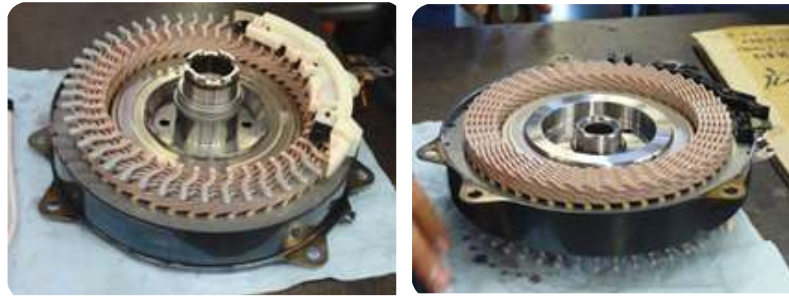
الشكل (6 - 11): المحرك/المولد الكهربائي الأول من الداخل.
