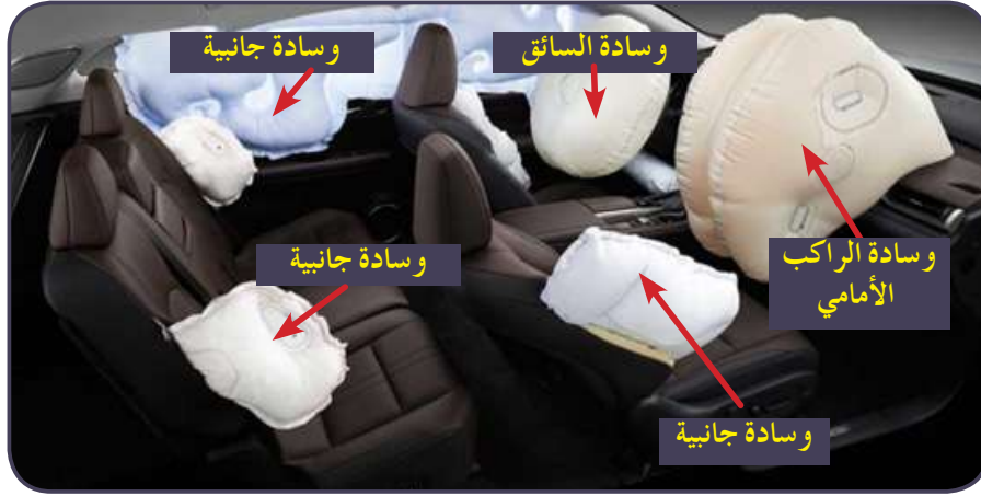
الشكل (5-5): أماكن تركيب الوسائد الهوائية في المركبة.
