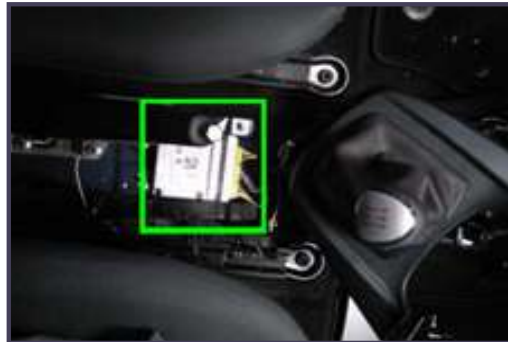
الشكل (5-15): موضع تثبيت وحدة التحكم الإلكترونية لنظام الوسائد الهوائية.
