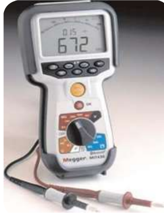
الشكل (6 - 23): جهاز فحص العازلية.
