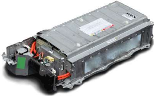
الشكل (1-6): وحدة المرمك ذي الفولتية العالية (HVB).
