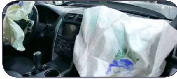
الشكل (5 - 19): تفريغ الوسائد الهوائية.
