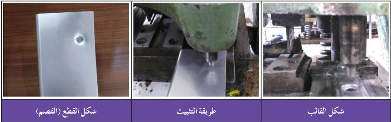
الشكل (4-7): مكبس أو قالب فصم أرضية الدرفة التي يُركب عجل السحاب على مقطعها.
