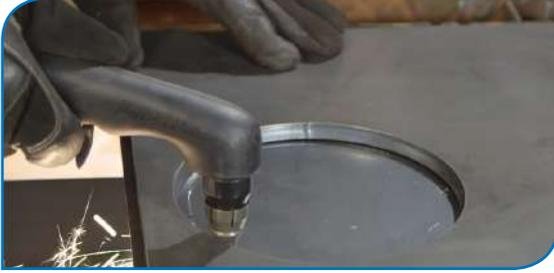
ما تشاهده في الصورة عملية قطع بالبلازما، فكيف يُقطع بالبلازما؟ هل يُستعمل الهواء المضغوط في عملية القطع بالبلازما؟
