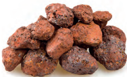
من المثال يتضح أن خام Fe 2 O 3 يحتوي على نسبة 69.9% من الحديد.
