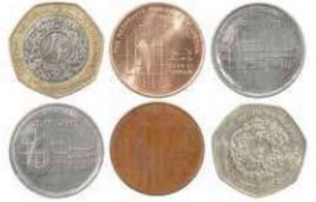
الشكل (6): عملة نقدية مصنوعة من مجموعة فلزات (نحاس، خارصين، قصدير، نيكل، حديد).
