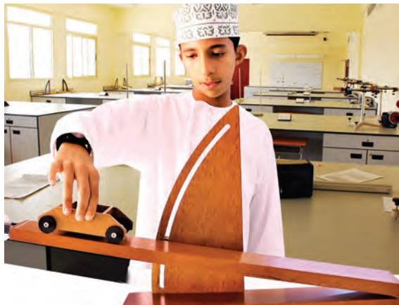
الصورة ٤-٦ يستقصي الطالب تسارع عربة تتحرك إلى أسفل منحدر مائل.
