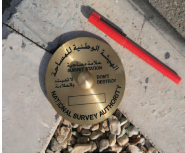
الشكل (١٥) نقطة تحكم أرضي
