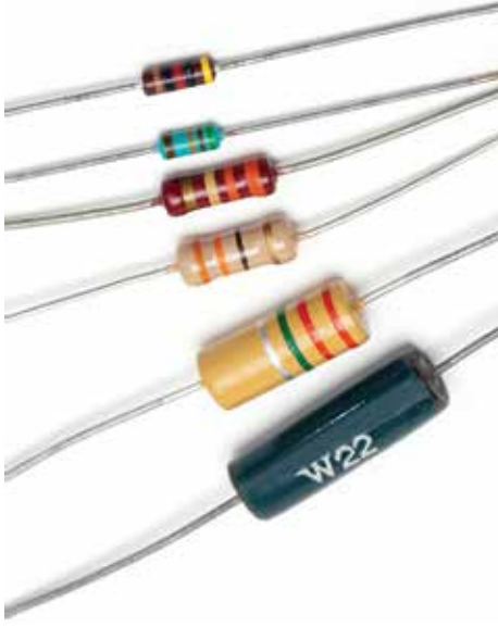
الصورة ٢-٢ مجموعة مختارة من المقاومات الثابتة، بعضها له ترميز من حلقات ملونة للإشارة إلى قيمة مقاومتها، وتستخدم الأخرى ترميزاً رقمياً
