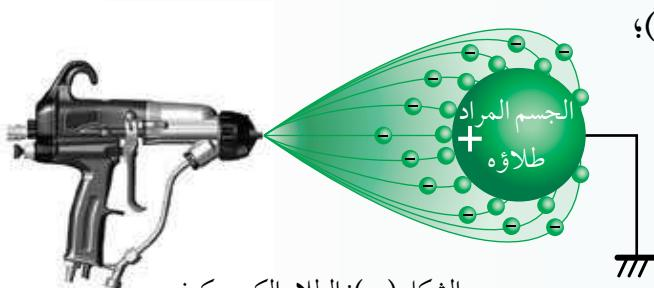
الشكل (ب): الطلاء الكهرسكوني.
