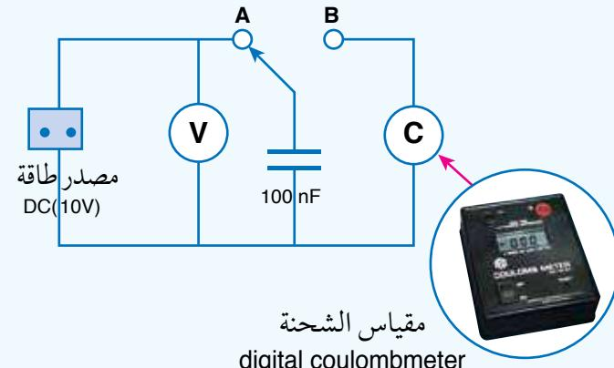
1. أعاير كلاً من الفولتميتر ومقياس الشحنة، ثم أصل أجزاء الدارة الكهربائية كما في الشكل؛ باستعمال جهد محدد (مثلاً 0.5 V) مع إبقاء الطرف الحر للمواسع غير متصل بأي طرف.
