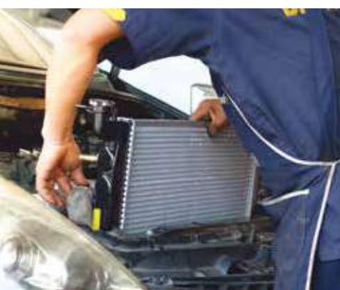
الشكل (5): يُستخدم الرادييتر في أنظمة التبريد؛ للتخلص من الطاقة الناتجة في أجزاء المحرك.
