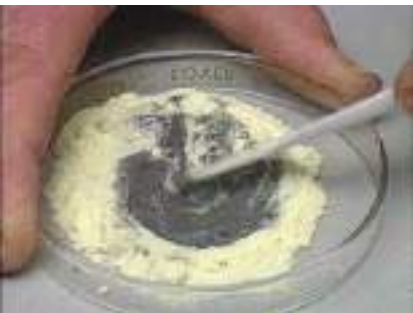
خلط برادة الحديد مع الكبريت
