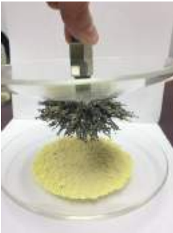
تنفصل برادة الحديد عن عنصر الكبريت بالمغناطيس
