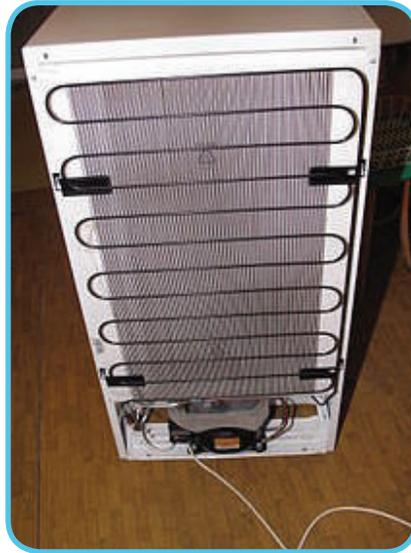
الشكل (4-12): مكثف مبرّد بالهواء بالحمل الطبيعي
