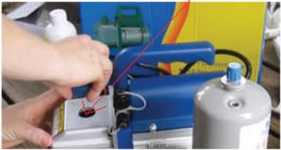
4 تأكد من وجود زيت كافٍ داخل مضخة التفريغ قبل تشغيلها، إذا نقص الزيت، فأضف كمية مناسبة من الزيت الخاص بمضخة التفريغ؛ بحيث يجب أن يكون مستوى الزيت أعلى من علامة MIN، وأقل من علامة MAX الظاهرة على زجاجة رؤية زيت مضخة التفريغ المبيئة في الشكل المجاور.
