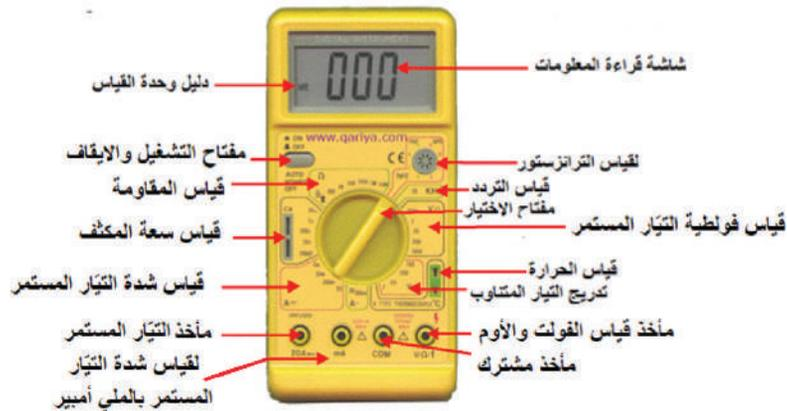
الشكل (12-3): جهاز قياس متعدد الأغراض الماليميلر الرقمي
