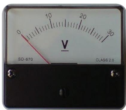
الشكل (5-3): أحد أنواع أجهزة قياس الفولتية.
