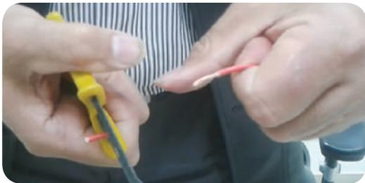
5 أحضر كبلين آخرين ثم قص العازل الكهربائي مسافة تتراوح بين 3 سم و4 سم بعناية الأسلاك الكهربائية المبينة في الشكل المجاور، ضع السلك (الكبل) في الثقب المناسب لمقاسه في أداة التعرية، ثم اسحب العازل بلطف دون التسبب بقطع شعيرات الموصل.
