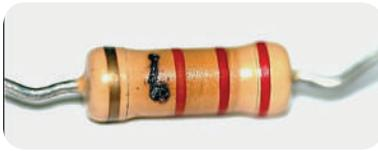
عندما تتلف المقاومة الكربونية، تظهر آثار الحرق على جسمها الخارجي، ويتسبب تلف المقاومة بفتح الدارة الكهربائية (Open Circuit).
