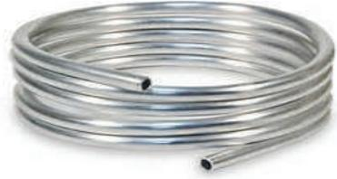
4. أنابيب الألمنيوم (Aluminium Tubes): أنابيب ملتفة، وخالية من الدرزات، ذات جدار رقيق، تتوافر بأقطار من 5/16 بوصة إلى 3/4 بوصة، تستخدم في: الثلاجات المنزلية، في المبخرات، وخطوط السحب. مكيفات الهواء، في مكثفات مكيفات الهواء المركزية، وأجهزة التبريد الصناعية. مكيفات هواء السيارات، في المبخرات، والمكثفات، وخطوط السائل، والخزانات.
