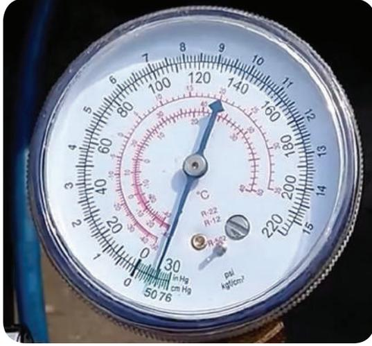
٧ صل مضخة التفريغ بالمصدر الكهربائي، ثم شغلها وراقب خروج الهواء من فتحة التفريغ، وراقب مؤشر مقياس الضغط المنخفض، ثم أغلق صمام مقياس الضغط، ثم افصل مصدر الكهرباء عن مضخة التفريغ، إذ يجب أن تثبت القراءة لمدة نصف ساعة تقريباً، إذا ارتفع المؤشر، فإن هذا يدل على وجود تسريب يجب معالجته ثم إعادة التفريغ.
