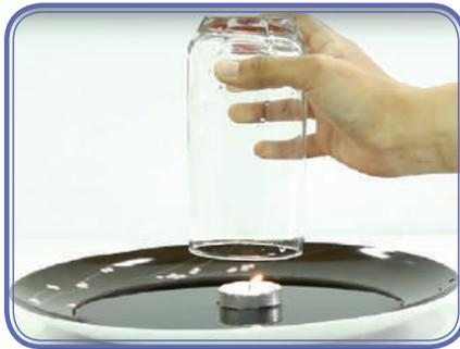
الشكل (7-1): تجربة الضغط الجوي وضغط التفريغ.
