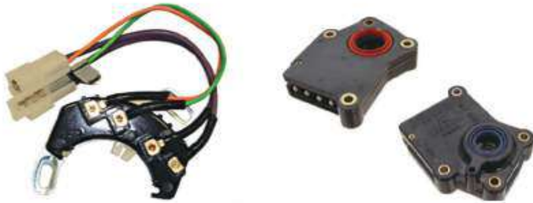
الشكل (5-26): مفتاح الأمان المحايد للمركبات المزودة بصندوق السرعات الآلي.
