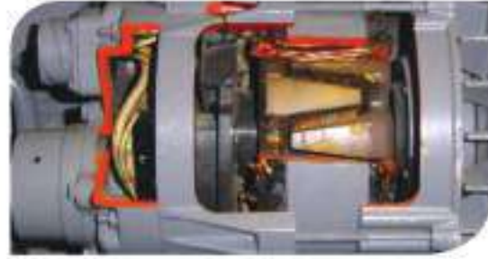
الشكل (6-7): مولد تيار متناوب ذو قطب مشطور.
