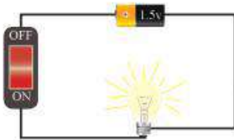
الشكل (4-15): دائرة كهربائية بسيطة.
