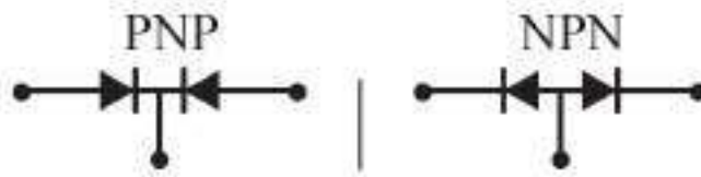
الشكل (4-31): تمثيل الانحياز لمنطق الاتصال في الترانزستور.
