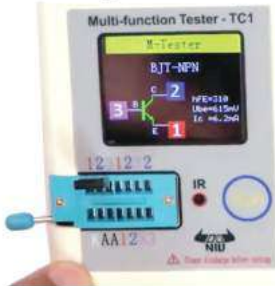
الشكل (4-37): جهاز فحص الترانزستور.
