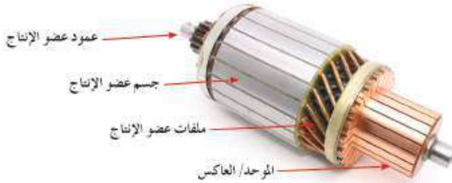
الشكل (5-13): العضو الدوار (عضو الإنتاج).
