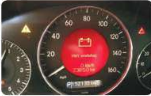
الشكل (6-24): إضاءة مصباح بيان عدم شحن البطارية.
