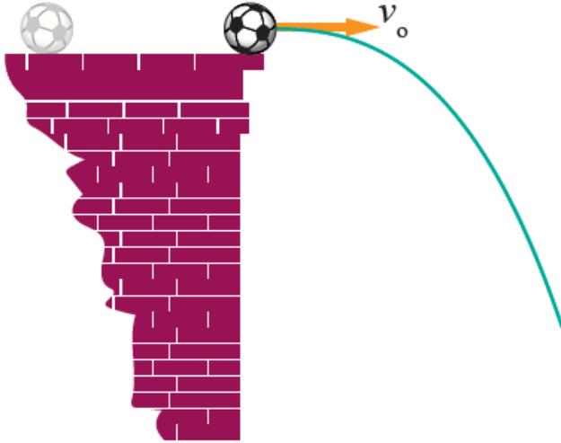
**أحسب:** قذفت كرة من فوق بناية ارتفاعها (44.1 m) عن سطح الأرض بسرعة أفقية مقدارها (12 m/s) كما في الشكل المجاور. أحسب زمن سقوط الكرة إلى سطح الأرض، والمسافة الأفقية التي قطعتها الكرة قبل ارتطامها بالأرض.
