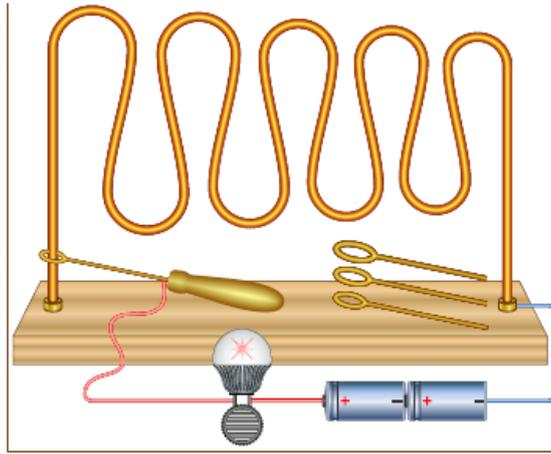
عندما تلامس الحلقة المسار تغلق الدارة الكهربائية بسبب مرور تيار كهربائي ينتج عنه إصدار صوت الجرس، وعند عدم تلامس الحلقة تكون الدارة مفتوحة بسبب عدم إصدار صوت الجرس، الذي يحتاج إلى تيار كهربائي في مسار مغلق ليصدر صوتاً.
