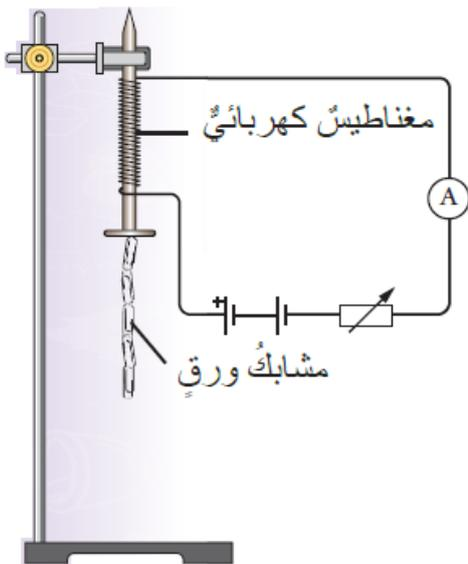
يبين الشكل المجاور مخططاً لتجربة لاستقصاء العلاقة بين عدد لفات سلك المغناطيس الكهربائي وقوة المغناطيس. والجدول يبين النتائج التي رصدت عند زيادة عدد لفات الملف، وعدد المشابك التي انجذبت إلى المغناطيس في كل مرة.
