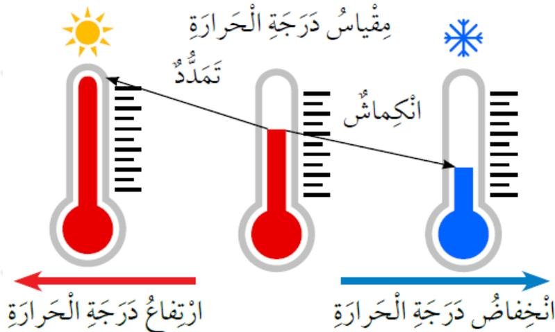
تستخدم ظاهرة انكماش السائل وتمده في ميزان الحرارة في قياس درجة حرارة
