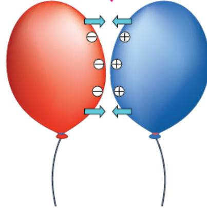
تسمى قوة التجاذب والتنافر بين الشحنات الكهربائية على الأجسام القوة الكهربائية.
