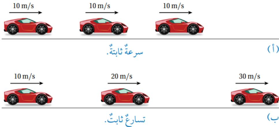
أتأمل الشكل، وأحدد في أي الحالتين تكون القوة المحصلة المؤثرة في السيارة صفراً؟ في الشكل (أ) تكون القوة المحصلة المؤثرة صفراً؛ لأنّ السيارة تتحرك بسرعة ثابتة في خط مستقيم.
